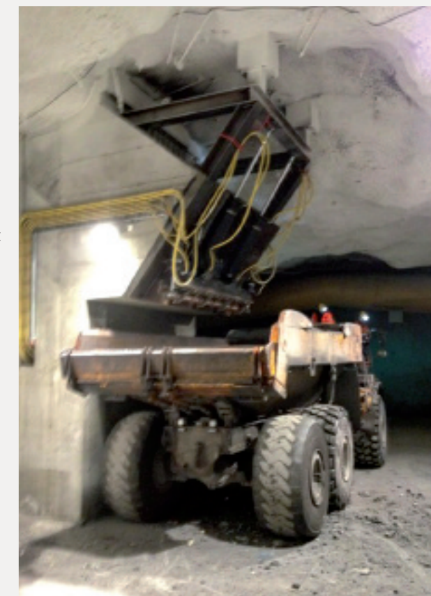
Bildet viser en truck som tappes fra sjakt 1.
