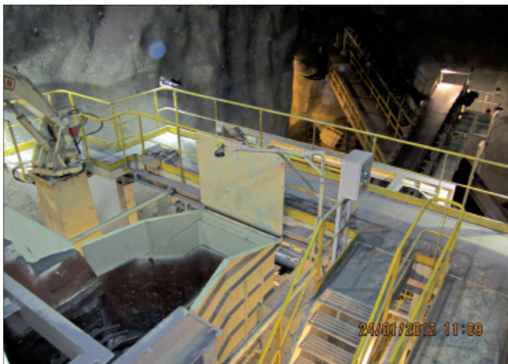
Bildet viser toppen av den nye knuseren, samt nedre del av bandanlegget
